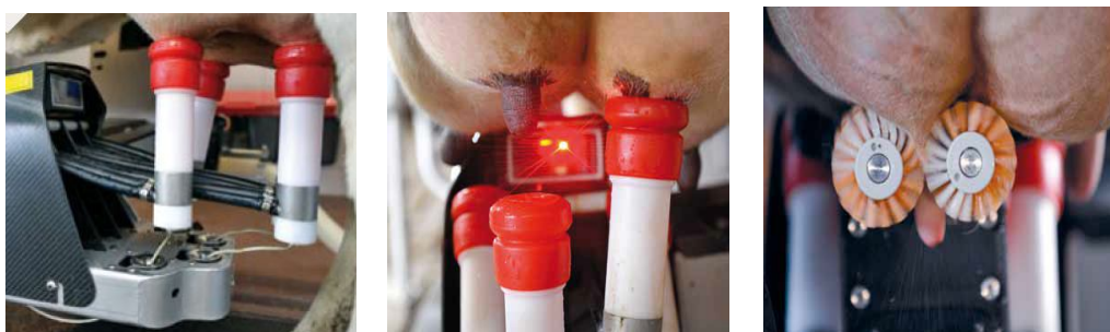
شکل ۳- برس‌های تمیزکننده پستان (راست)، نحوه نصب لاینرها (وسط) و بازوی شیردوشی (چپ) در ربات‌های شیردوش
