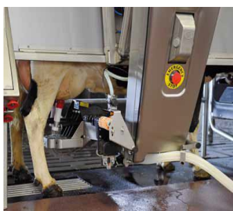
شکل ۲- نحوه تعیین موقعیت پستان‌های گاو در ربات شیردوش برای نصب بازوهای شیردوشی.
