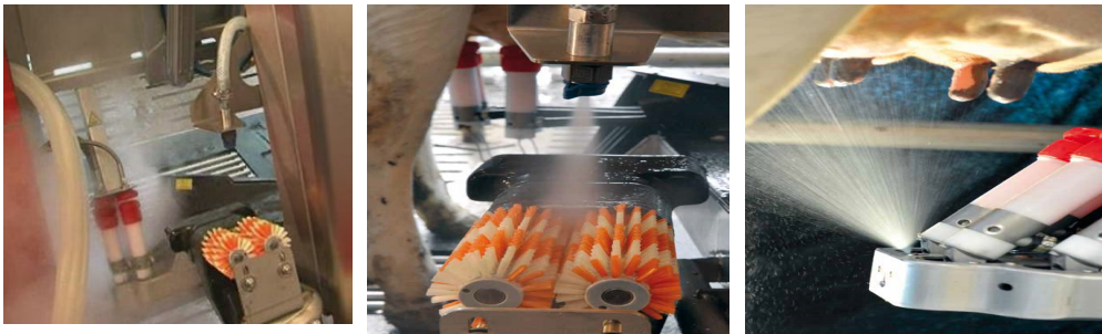
شکل ۴- سامانه ضدعفونی کننده پستان (راست)، سامانه ضدعفونی کننده برس‌های تمیزکننده پستان (وسط) و سامانه ضدعفونی کننده لاینرها (چپ) در ربات‌های شیردوش.
